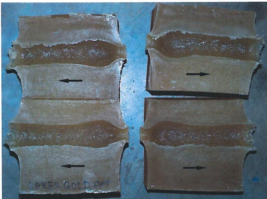
Figur 5 Penetrationskanaler i tvåblock, SPEER Gold Dot
