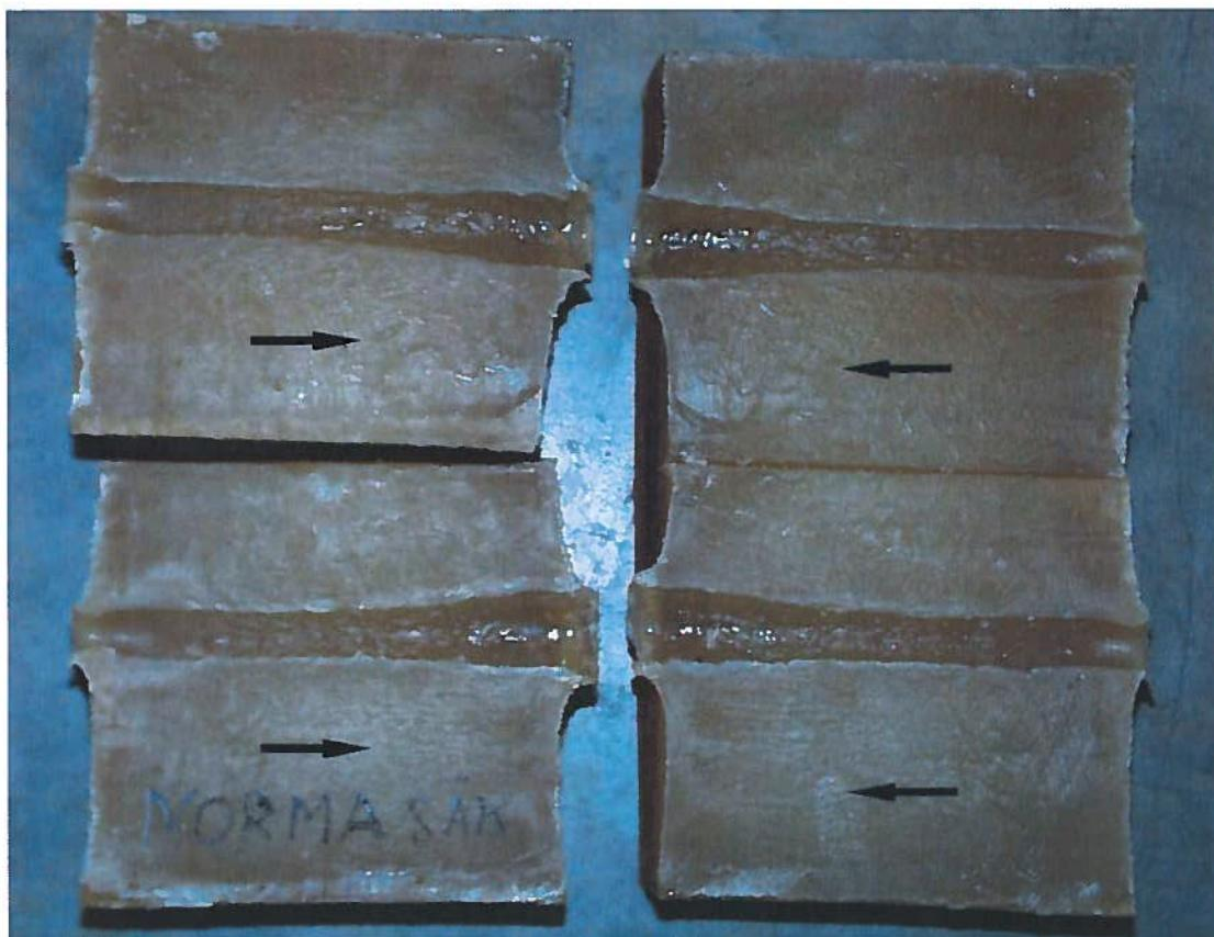
Figur 4 Penetrationskanaler i tvåblock, NORMA Säkerhetspatron
