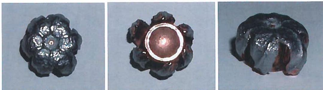
Figur 3 SPEER Gold Dot efter perforation av tvåblock och uppfångning i aramidväv
