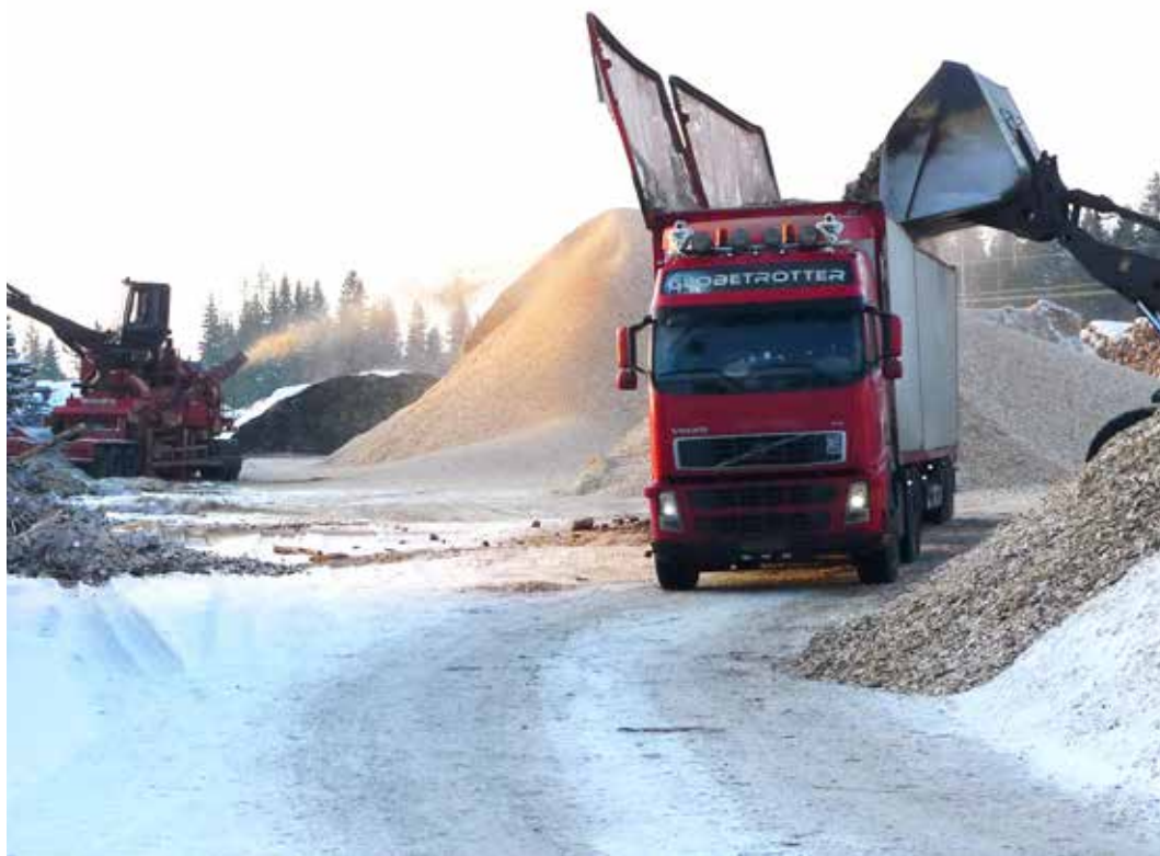
Flisterminal med energivirke, flishogging og opplasting av flis.
