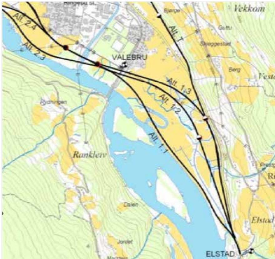
Detaljregulering E6 Ringebu, indre linje 1.3 og ytre linje 1.1. Kilde: Statens vegvesen Region øst 94
