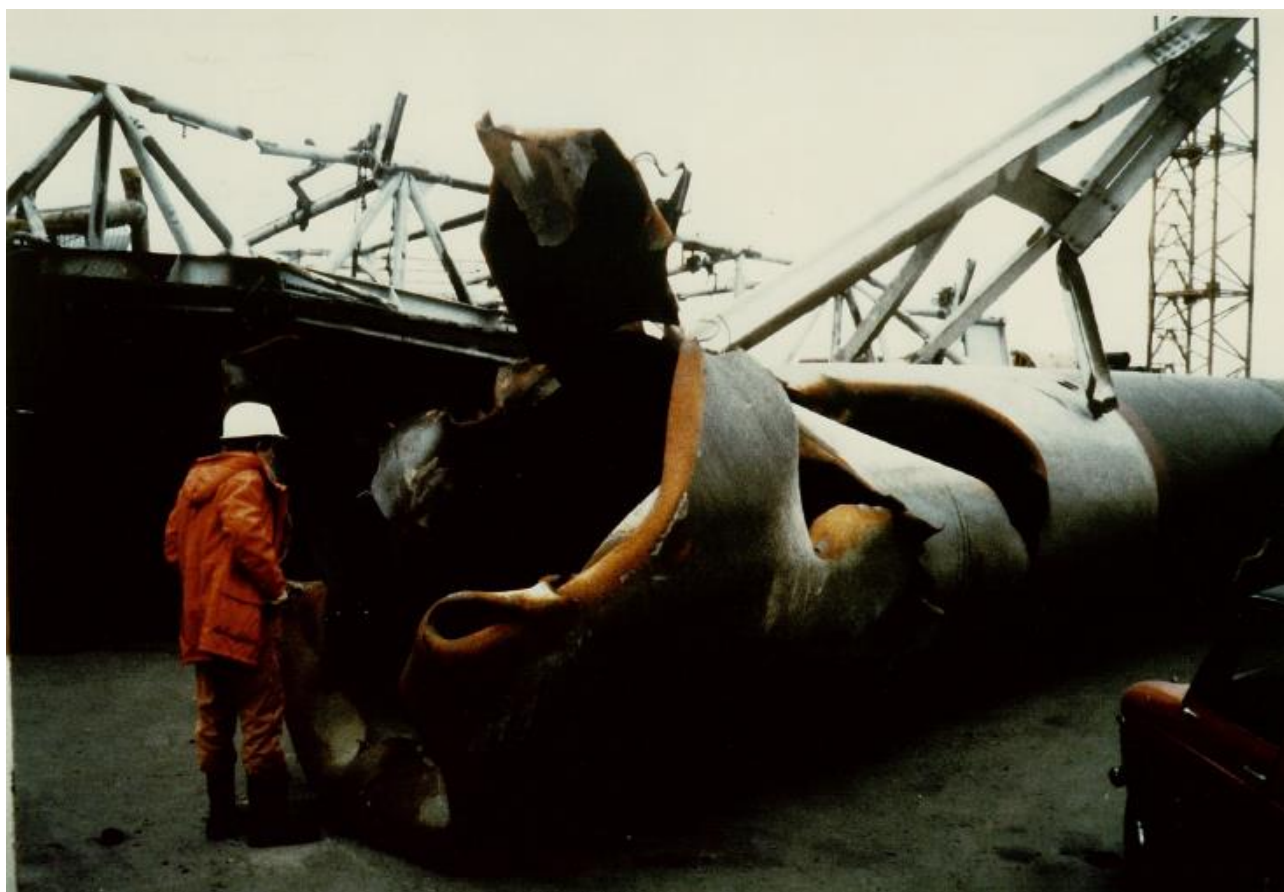
Den innkrøllede D4-bruddflaten. Foto: Bjørn Lian.
